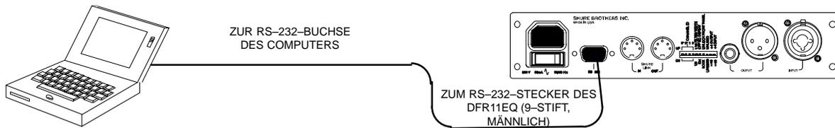
1. Feststellen, ob es sich bei dem RS-232-(COM)-Anschluß des Computers um einen 9-poligen oder einen 25-poligen Anschluß handelt. Entweder ein 9-Stift-zu-9-Stift- oder ein 9-Stift-zu-25-Stift-RS-232-Kabel ist erforderlich. RS-232-Kabeldiagramme sind im [Anhang B: Kabel](#) zu finden.
