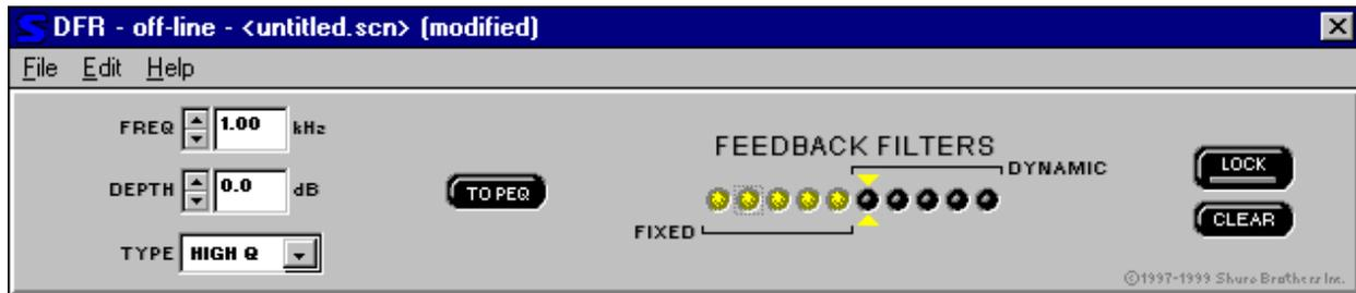
Das Bedienfeld der Rückkopplungsreduzier-Stufe ermöglicht es, neue Rückkopplungsfilter hinzuzufügen bzw. die Frequenz, die Tiefe und den Typ vorhandener Filter zu bearbeiten. Zum Zugriff auf das Steuerfenster der digitalen Rückkopplungsreduzier-Stufe auf die Schaltfläche DFR im Hauptbedienfeld klicken.
