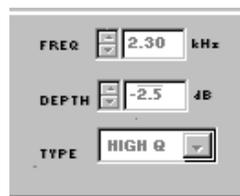
**FREQ.** — Dieses Feld zeigt die Frequenzmitte des ausgewählten Filters an. Auf die Schaltflächen  $\uparrow$  und  $\downarrow$  klicken, um die Frequenz des Filters anzupassen, oder die gewünschte Frequenz in das Feld eingeben.
